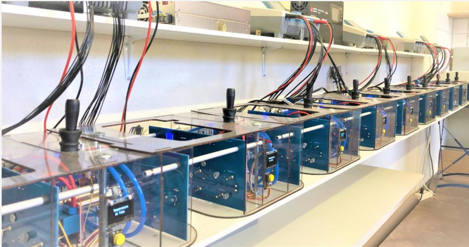
Systeme de test pour modules de cellules
