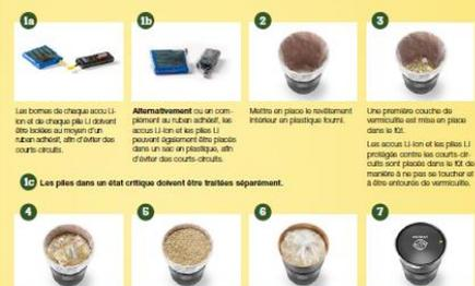
**1a** Les bornes de chaque accus Li-ion et de chaque pile Li doivent être isolées au moyen d'un ruban adhésif, afin d'éviter des courts-circuits.
